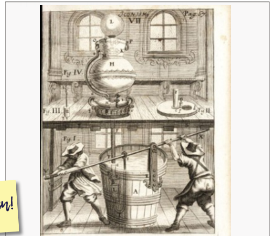
Caspar Schott, Technica curiosa , Würzburg 1664 Arbeitsteilung an einer High-Tech-Maschine des 17. Jahrhunderts: Die Luftpumpe steht zum Experimentieren im Labor, während im Kellergeschoss Gehilfen dafür arbeiten, das Vakuum herzustellen.
